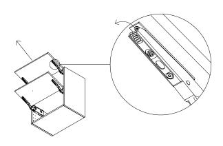
IN CASE YOU NEED TO DETACH THE FRONTS FROM THE HINGES, SIMPLY PULL THE TIP OF THE HINGE.
