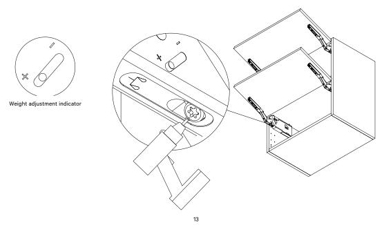
FOR THE HINGES TO OPEN PROPERLY, THE HINGES NEED TO BE ADJUSTED TO THE WEIGHT OF THE FRONTS. SCREW TO ADJUST THE HINGE AS SHOWN IN THE IMAGE.
