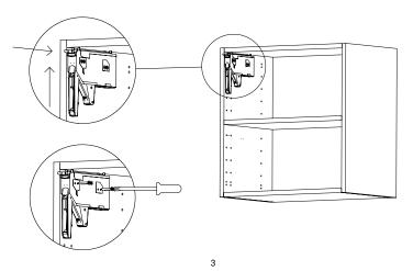
FASTEN A HINGE TO EACH SIDE OF THE CABINET WITH 2X CHIPBOARD SCREWS. MAKE SURE TO USE THE YELLOW PLASTIC PIECE TO ALIGN THE HINGES WITH THE SIDES AND TOP OF THE CABINET BEFORE FASTENING.
