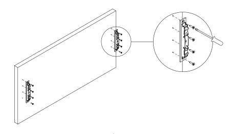
NOW FASTEN THE HINGE BRACKETS TO THE FRONT YOU WANT TO CONNECT TO THE HINGE BY INSERTING THE SHORT WOOD SCREWS INTO THE PRE-DRILLED HOLES.
