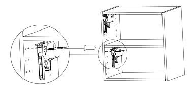
THE HINGE CAN NOW BE FASTENED TO THE SIDE OF THE CABINET WITH CHIPBOARD SCREWS. MAKE SURE THE HINGE IS ALIGNED WITH THE EDGE AND THE MARKINGS FROM THE CENTER PUNCH. REPEAT ON THE OPPOSITE SIDE OF THE CABINET.
