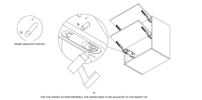
THE FRONTS. SCREW TO ADJUST THE HINGE AS SHOWN IN THE IMAGE.
