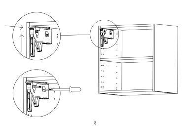
FASTEN A HINGE TO EACH SIDE OF THE CABINET WITH 2X CHIPBOARD SCREWS. MAKE SURE TO USE THE YELLOW PLASTIC PIECE TO ALIGN THE HINGES WITH THE SIDES AND TOP OF THE CABINET BEFORE FASTENING.
