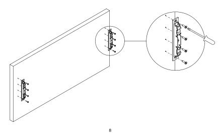
NOW FASTEN THE HINGE BRACKETS TO THE FRONT YOU WANT TO CONNECT TO THE HINGE BY INSERTING THE SHORT WOOD SCREWS INTO THE PRE-DRILLED HOLES.
