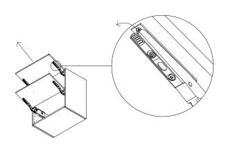
$$\rm 15$$  IN CASE YOU NEED TO DETACH THE FRONTS FROM THE HINGES, SIMPLY PULL THE TIP OF THE HINGE.
