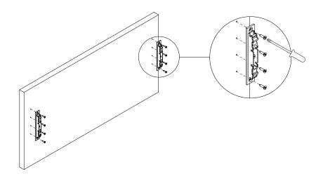
$$8\,$  NOW FASTEN THE HINGE BRACKETS TO THE FRONT YOU WANT TO CONNECT TO THE HINGE BY INSERTING THE SHORT WOOD SCREWS INTO THE PRE-DRILLED HOLES.
