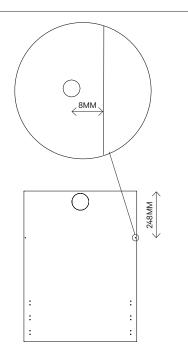
1 MARK THE POSITION OF THE DRILLINGS ON THE BACK SIDE OF THE DRAWER FRONT. DRILL 12MM DEEP HOLES USING A 2MM DRILL BIT
